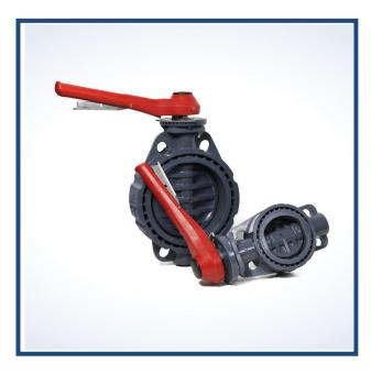
LAS *VÁLVULAS DE MARIPOSA IMPLEX®* DE SISTEMA GATILLO, REGULAN EL CAUDAL DEL FLUIDO GRACIAS A SU SISTEMA EXCLUSIVO DE CORONA DENTADA DE ACERO INOXIDABLE A-2 MONTADA SOBRE PARTE SUPERIOR DE LA VÁLVULA QUE PERMITE REGULAR HASTA ONCE POSICIONES DIFERENTES.
